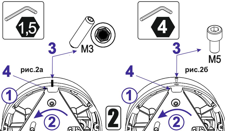
**Закрепите** кронштейн **1** на монтажной поверхности с помощью крепежных элементов (в комплект не входят), предварительно **выведите** питающий провод **2** через отверстие **3**\*.
