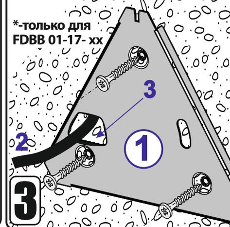
**Установите** светильник **1** на кронштейн **2**, для чего, отрегулируйте его таким образом, чтобы он был повернут примерно на 20 градусов против часовой стрелки относительно кронштейна **2** (см.рис.4а);
