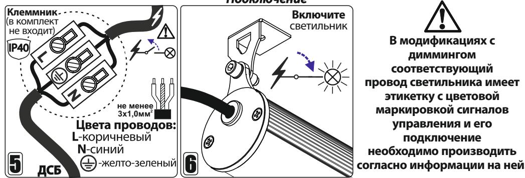
В модификациях с диммингом соответствующий провод светильника имеет этикетку с цветовой маркировкой сигналов управления и его подключение необходимо производить согласно информации на ней.
