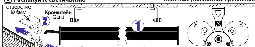
1. Закрепите светильник 1 (используя отверстие в кронштейне 2) на монтажную поверхность с помощью винтов, болтов, саморезов (в комплект не входят).
